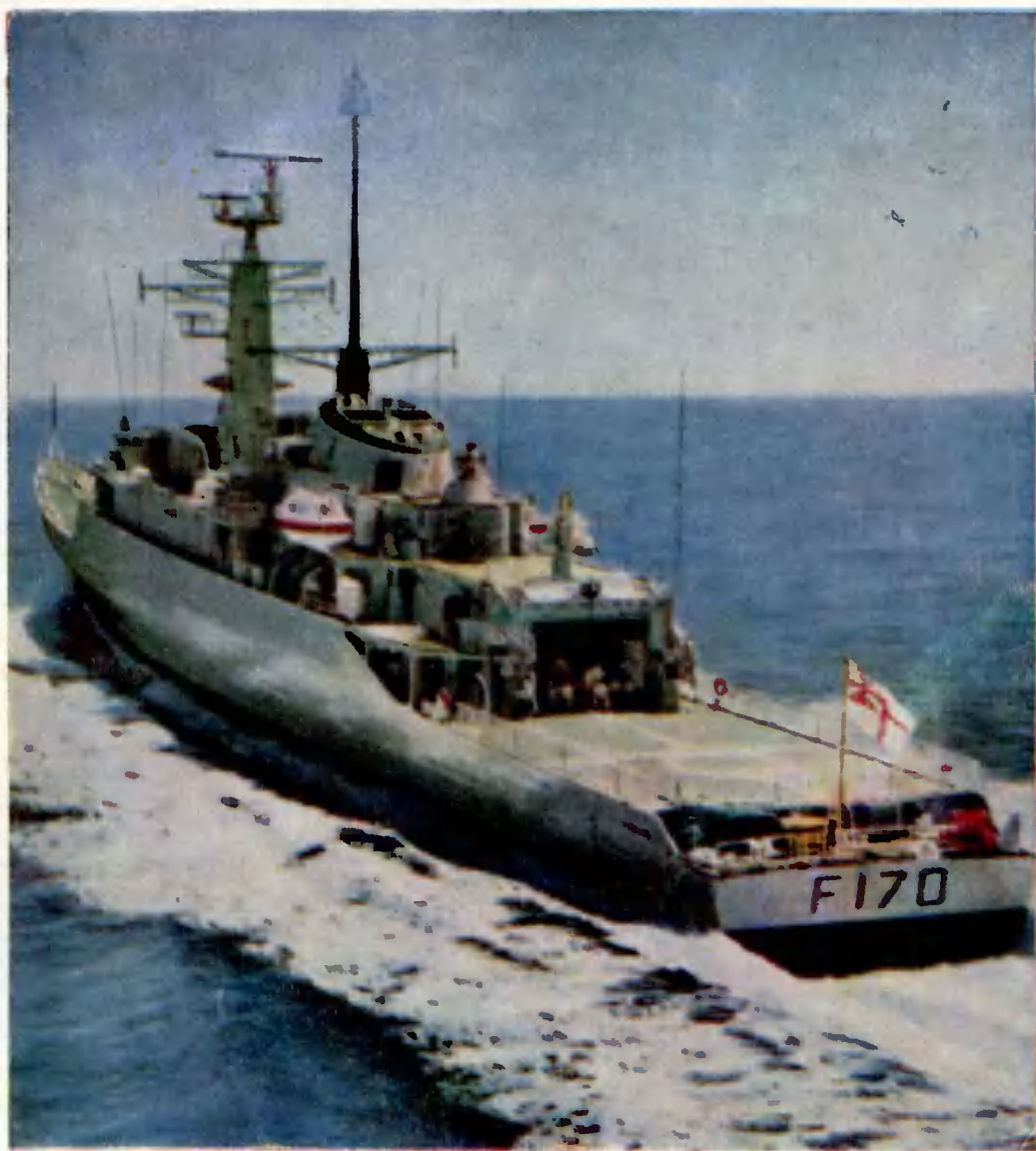
АНГЛИЙСКИЙ ФРЕГАТ F170 «АНТИЛОУП» типа «Амазон» (проект 21). Его стандартное водоизмещение 2000 т, полное 2500 т; длина 117 м, ширина 12,7 м, осадка 3,7 м; мощность энергетической установки 50 000 л. с.; наибольшая скорость хода 34 узла; дальность плавания 4500 миль при скорости хода 18 узлов; вооружение: система ЗУР «Си Кэт», 114-мм универсальная башенная артиллерия, два трехтрубных торпедных аппарата для стрельбы противолодочными торпедами, вертолет WB13 «Линкс». Экипаж 170 человек, из них 11 офицеров.
